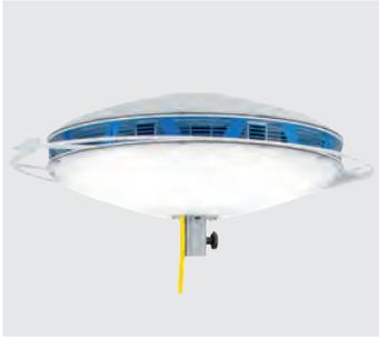
Gehäuse Aluminium / Edelstahl, Abdeckung Polycarbonat opal, 10 m Zuleitung mit Netzstecker, inkl. Adapter für DIN-Zapfen-Aufnahme (DIN 14640) mit der Möglichkeit einer geraden oder 30° geneigten Montage.
