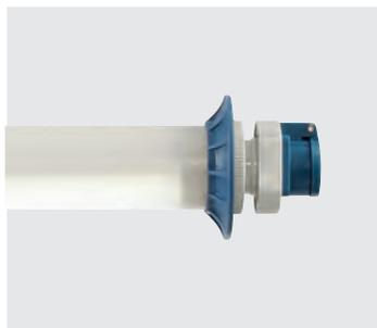
Schutzrohr aus schlagfestem Kunststoff opal (Polycarbonat), Endkappen aus Kunststoff (grau/ Polyamid), Betriebsgerät und Akku integriert, 2 Protektoren (blau), 5 m Zuleitung mit Netzstecker, Notlichtfunktion mit reduziertem Leuchtenlichtstrom für max. 120 min. bei vollem Akku, Notfunktion für Transport / Lagerung ausschaltbar.
