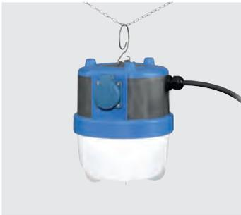
Gehäuse Kunststoff (Polycarbonat, Kantenschutz mit weichem, thermoplastischem Elastomer TPE), Abdeckung Kunststoff opal (Polycarbonat), einklappbarer Aufhängehaken aus Edelstahl mit Fallsicherung, zweite Kabeleinführung optional (Netzweiterleitung), 5 m Zuleitung mit Netzstecker.
